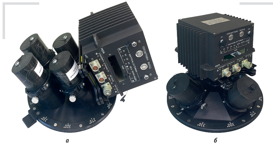
Рис. 5. Научный аппарат «Терминатор»: а – комплект для регистрации СО; б – комплект для регистрации эмиссионного слоя в окрестности солнечного терминатора
